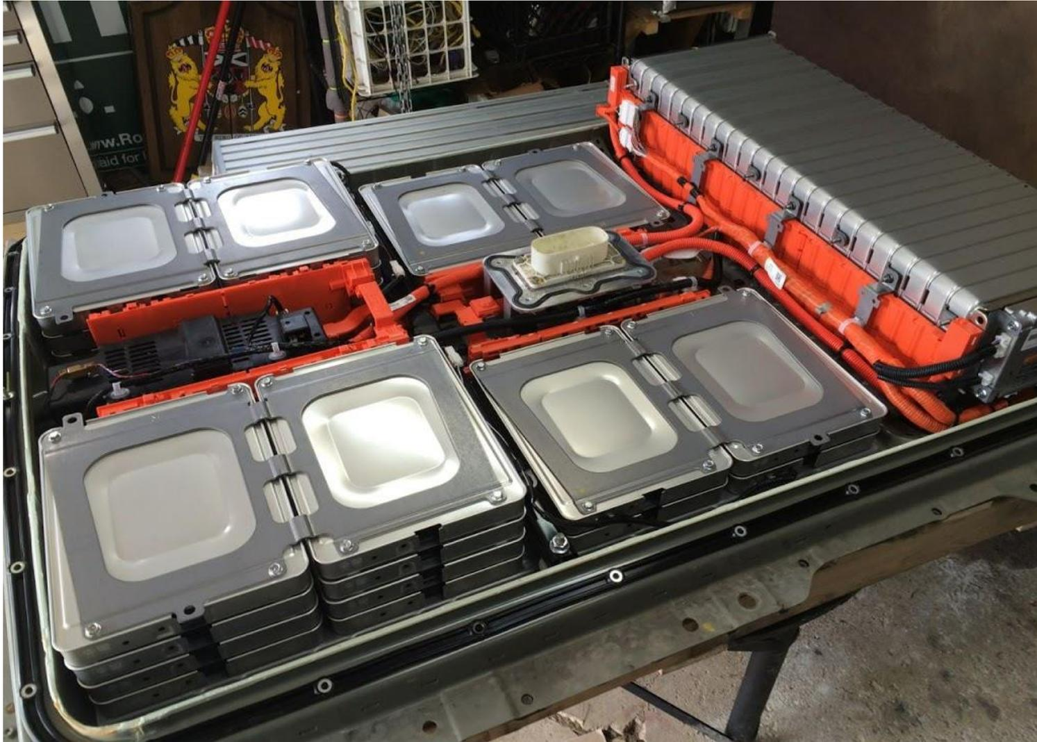
Il collegamento delle tre sezioni distinte dei moduli che costituiscono il pacco batteria, avviene in serie
