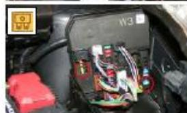
3. Sicherungskasten 2 lokalisieren und öffnen.
