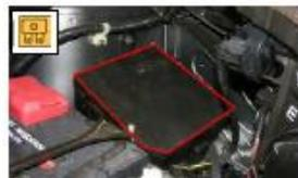
2. Dargestellte Sicherungen im Kastendeckel entfernen.
