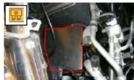
4. Dargestellte Sicherung im Kastendeckel entfernen.
