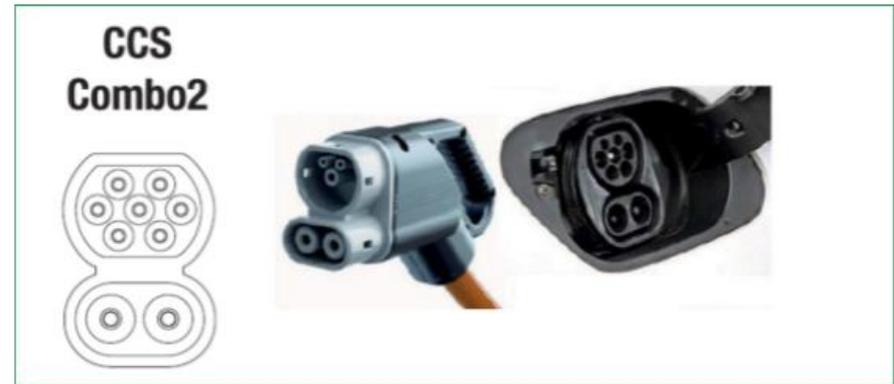
**CCS (Combined Charging System)** consiste in un unico connettore di ricarica sul veicolo, che **consente sia la ricarica rapida in corrente continua (DC) sia la ricarica lenta in corrente alternata (AC).** In Europa è realizzato a partire dal connettore Tipo 2, cui prende il nome di **Combo2.** **Presente sui veicoli (BMW e Volkswagen).**
